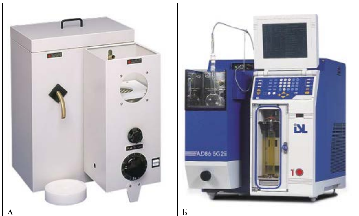
Сл. А14.2. Апаратура за одредување на дестилациона крива при атмосферски притисок. А – мануелно одредување, Б – автоматско одредување
