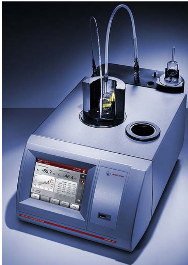
Сл. А15.1. Изглед на автоматизирана апаратура за одредување на најниска температура на филтрабилност на дизел горивата
