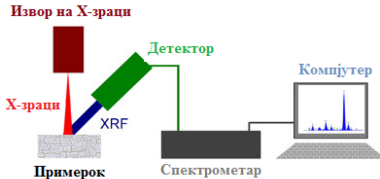
Сл. A18.5. Клучни компоненти на типичен XRF спектрометар.
