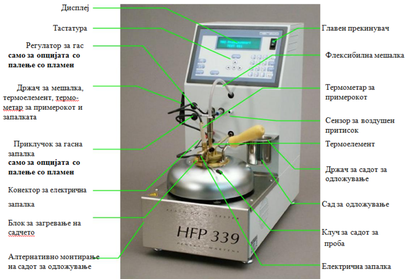
Сл. А12.1. Изглед на апарат за автоматско одредување на точката на палење HFP339.
