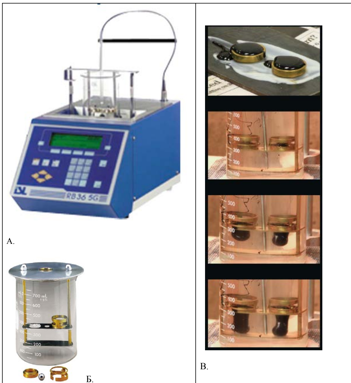
Сл. А34.1. Апаратура за одредување на температура на омекнување. А – општ изглед на автоматизирана апаратура. Б - чаша со држач, прстени и метално топче. В – припрема на дисковите од битумен и приказ како со зголемување на температурата металното топче тоне низ битуменот.
