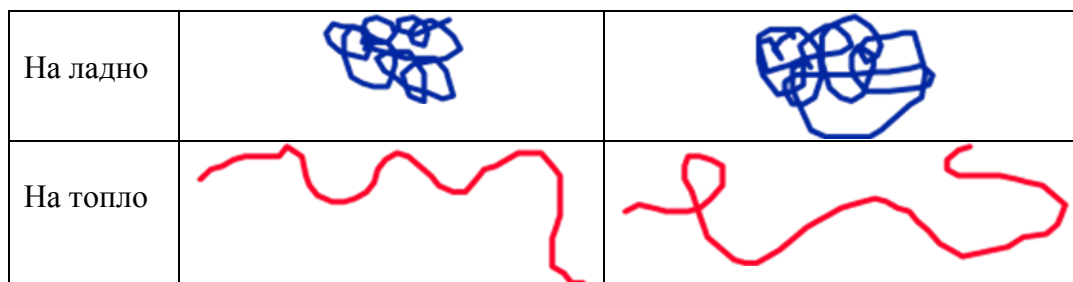
Сл. 6.23. Контури на модификатори на вискозноста на ниски и високи температури.
