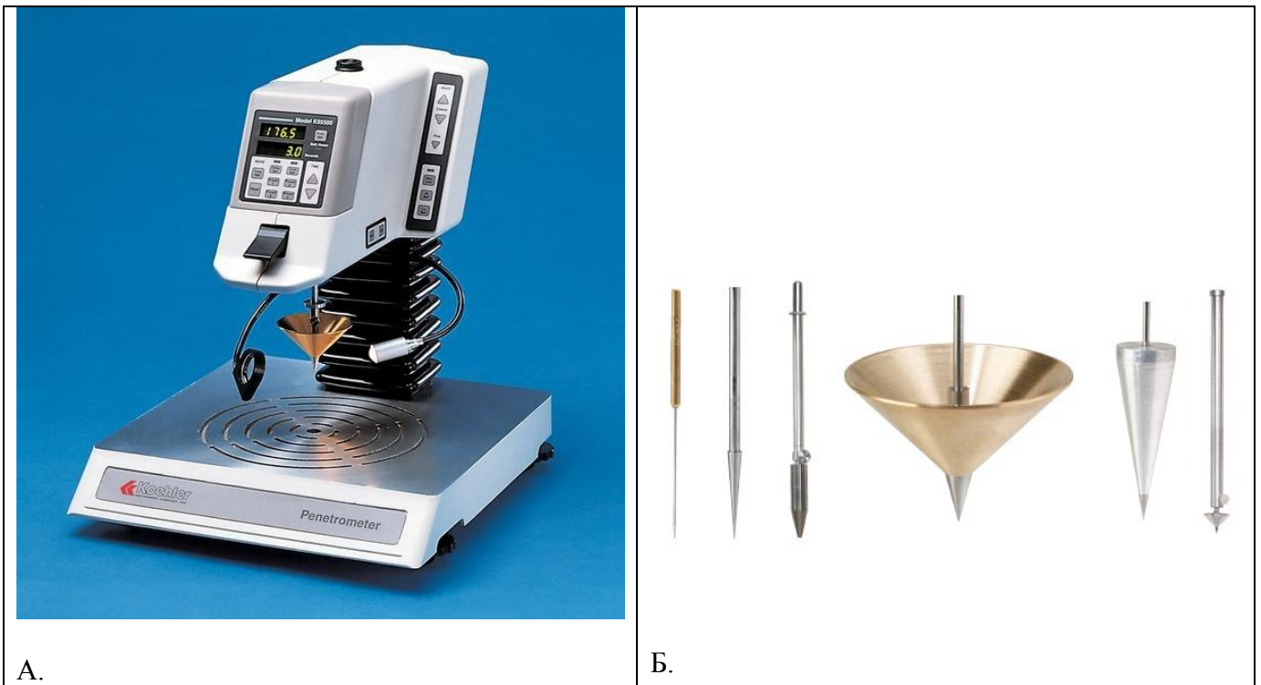
Сл. А29.2. Изглед на автоматизиран пенетрометар (А) и различни тела за пенетрација (Б)
