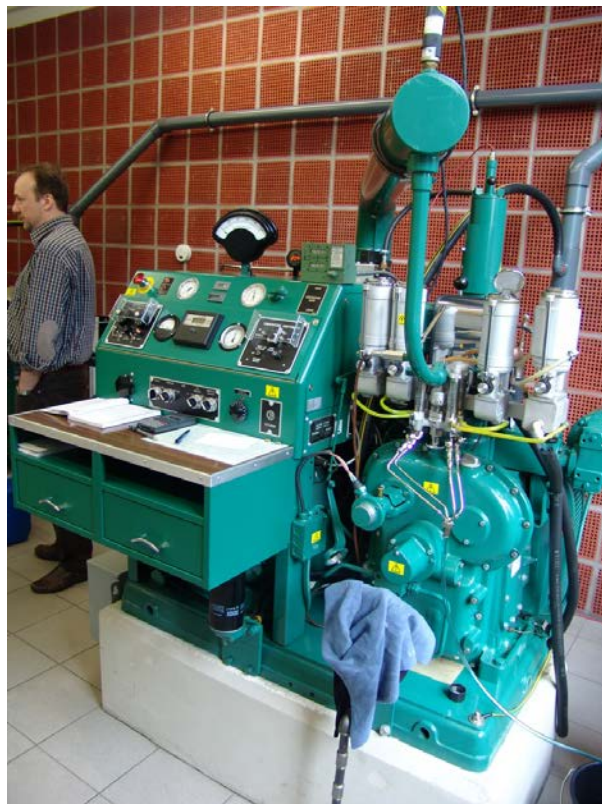
Сл. А20.1. Изглед на CFR дизел мотор за одредување на цетански број на дизел горивата.
