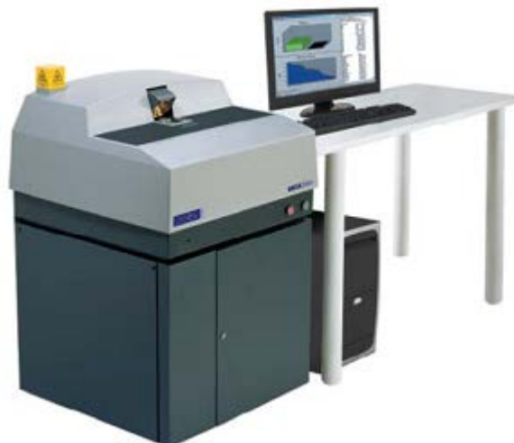
Сл. А18.8. Изглед на апаратот Oxford Instruments MDX1000 WDXRF анализатор.
