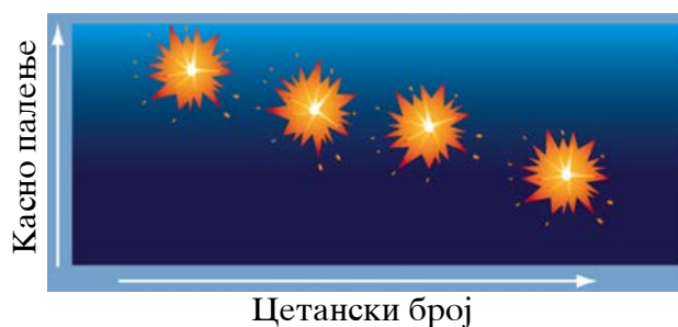
Сл. 5.3. Зависност на касното палење на дизел моторите од цетанскиот број
