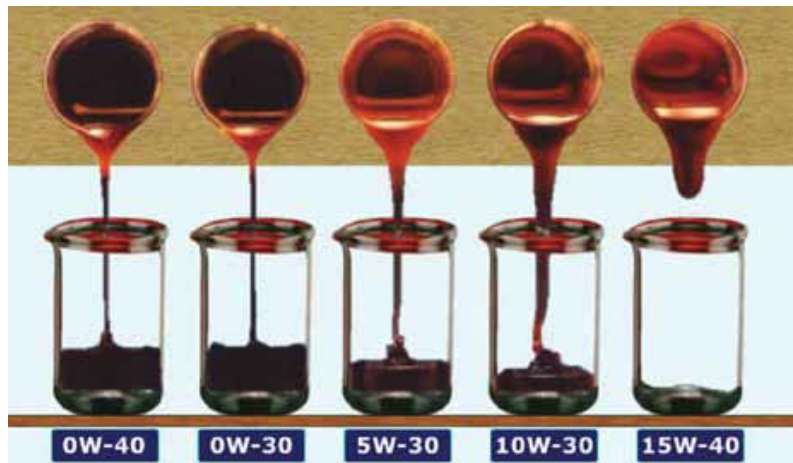
Сл. 6.3. Температурен интервал на течење за некои SAE класи на вискозност
