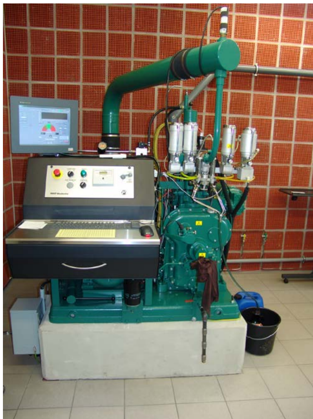
Сл. А13.1. Изглед на CFR бензински мотор за одредување на октански број на бензински горива.
