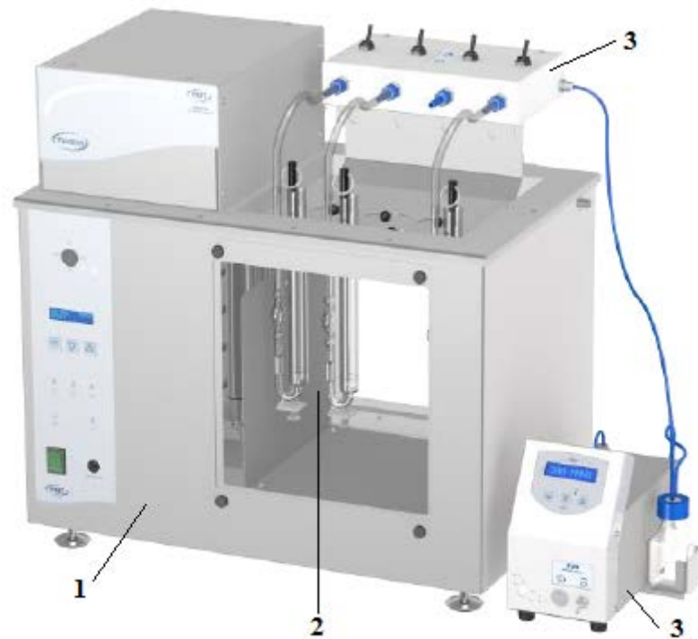
Сл. А33.2. Изглед на апаратура за одредување на вискозност со „вакуум капиларни вискозиметри“: 1 – термостатирана бања; 2 - вакуум капиларни вискозиметри; 3 – вакуум систем.
