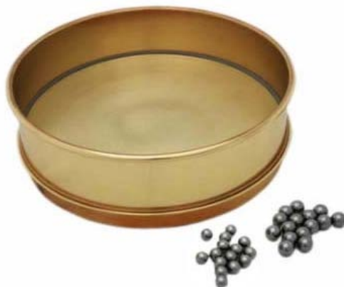
Сл. 9. 41. Тава со топчиња. Димензии: тава - дијаметар 203 mm, висина од 52 mm; 15 челични топчиња со дијаметар од 9,5 mm и 15 топчиња со дијаметар од 12,7 mm.
