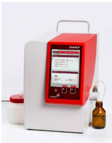
Сл. А11.1. Апарат за мерење на парен притисок на нафта и нафтени деривати (Eravap)
