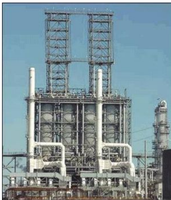
Сл. 9. 25. Постројка со четири кули за рафинериско пролонгирано коксирање
