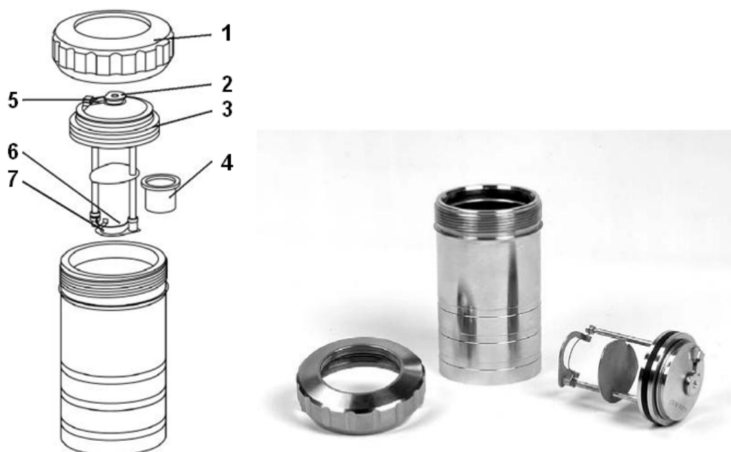
Сл. А9. 2. Опис на калориметриска бомба (1. Стегач, 2. вентил за кислород, 3. Капак, 4. Садче, 5. контакт за електрично палење, 6. жица за палење, 7. држач за садчето).
