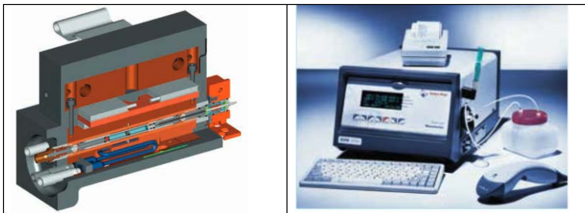
Сл. A25.1. Stabinger-ов принцип за одредување на вискозноста на течности
